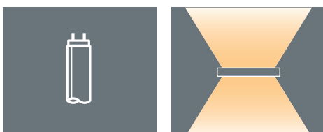
TYCOON Leuchtstoff: optimale Dosierung von Direktlicht nach unten und Indirektlicht nach oben.
